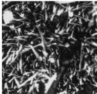
Muestras de concreto tratadas con Xypex Admix NF al 0.8% y 1.2% fueron examinadas para permeabilidad de agua comparándolas con muestras de control. Todas las muestras fueron sometidas a una presión de 10 bares (100 metros / 328 pies de columna de agua) durante 2 semanas. Se calcularon los coeficientes de permeabilidad de agua y las muestras tratadas con Xypex Admix mostraron una reducción importante de permeabilidad hasta 93% en el caso de la dosificación de 1.2%.
