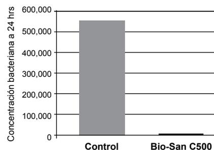
Se preparó concreto en cilindros de 100 x 200 mm con mezclas de control y tratadas. Se escogió una instalación de aguas residuales que tenía niveles elevados de  $H_2S$  y con un daño substancial de corrosión microbiana inducida (MIC). Dichas muestras de prueba fueron colgadas en el espacio de aire del tanque durante 10 años. Los análisis de exposición mostraron que el concreto tratado tenía nueve veces menos pérdida de masa comparado con las muestras de control.
